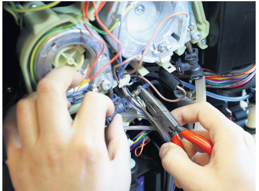
Die Reparatur und Revision von Kaffeemaschinen benötigt Fingerspitzengefühl und handwerkliches Geschick. In Siebträgermaschinen ist auch heute noch viel Mechanik und wenig Elektronik vorhanden.
